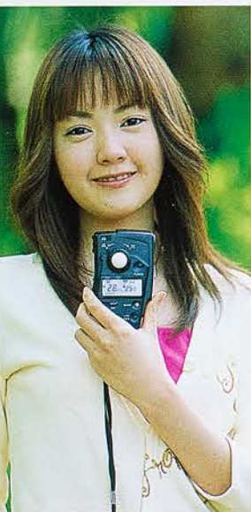
入射式露出計はモデルの顔の下当たりで測るのが基本。光球の角度や光の当たり具合によって、測定値は微妙に変わっていくので、自分なりの測り方を身につけることが肝心だ。
